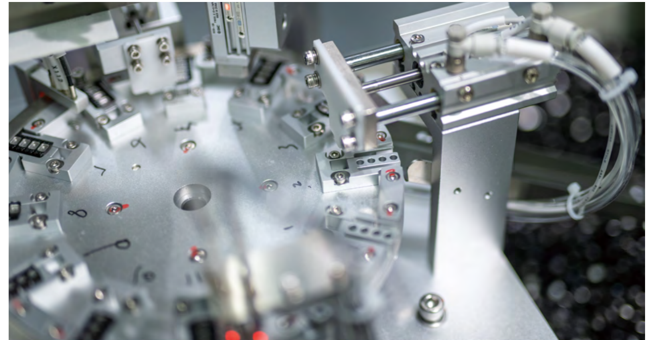
工厂的雾化芯全自动钢盖安装设备，让工作效率得到有效提高
