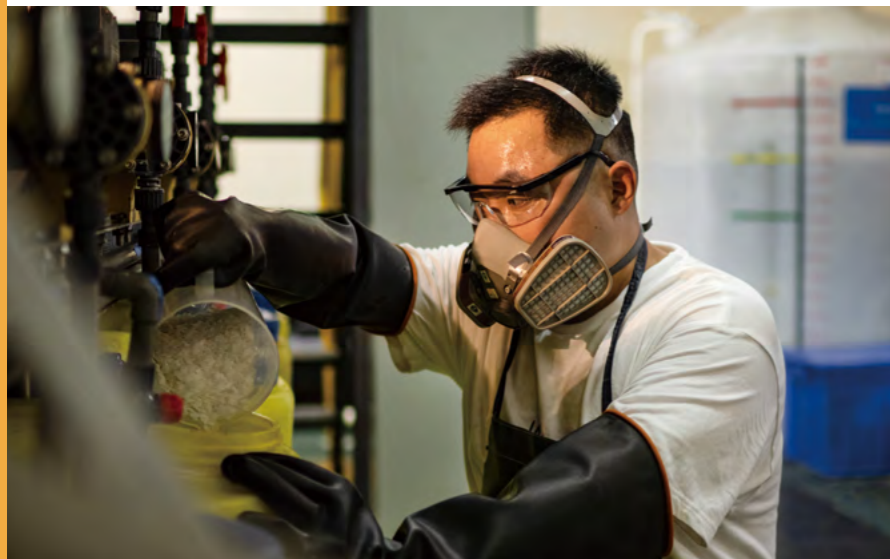
工作人员向废水处理装置中添加中和剂
