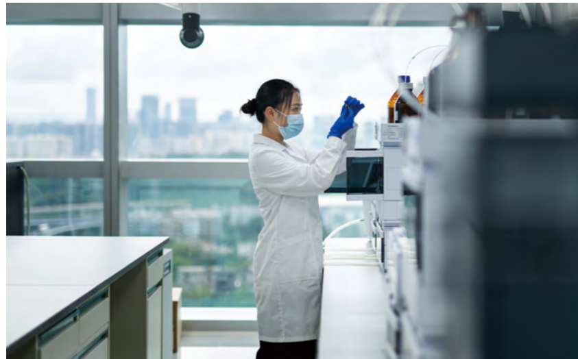
化学分析负责人梁晶晶博士检查超高效液相色谱仪的流动相，准备进行羰基化合物测试
