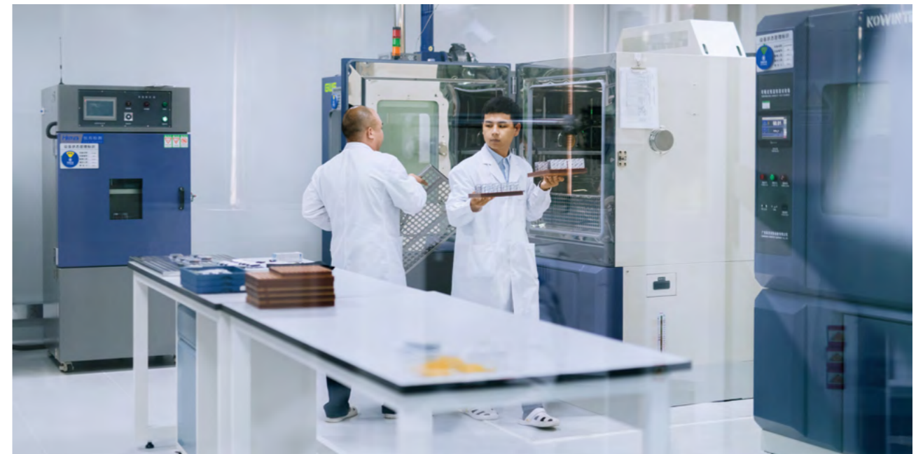
品质测试工程师在品质安全实验室中对雾化弹开展耐高温、高湿测试
