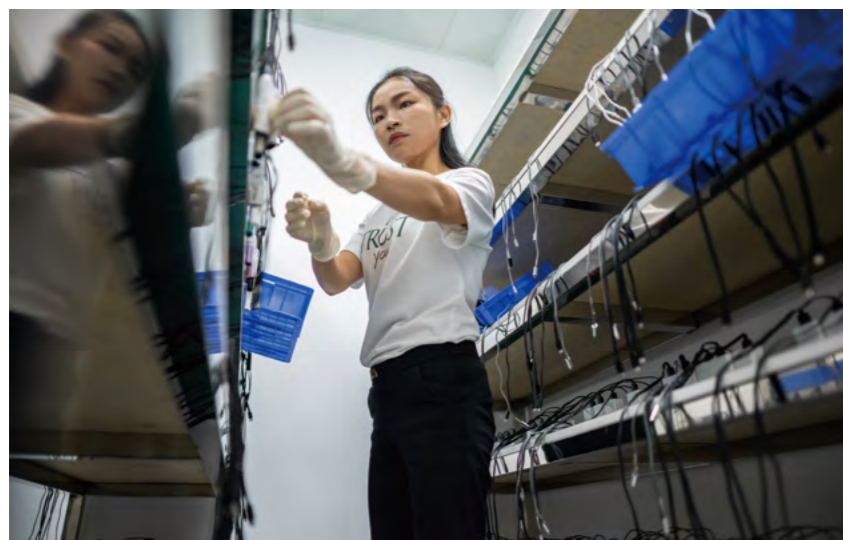
售后品质检测中心，工作人员对售后产品进行充电老化测试
