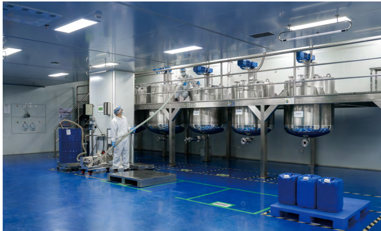
工作人员使用转子泵将雾化物原料投入配料罐
